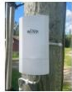
A-tolpassa Wi-Tek WI-CPE111KIT vastaanotin
